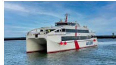
MS „Nordlicht II“ (2021) Länge: 46,80 m Breite: 11,00 m Tiefgang: 2,40 m Leistung: 2x 2960 kW Geschwindigkeit: 35 kn
