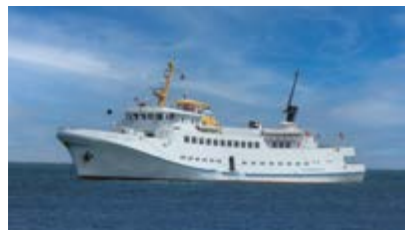
MS „Fair Lady“ (1970) Länge: 68,57 m Breite: 10,00 m Tiefgang: 2,32 m Leistung: 3.800 PS Geschwindigkeit: 19 kn
