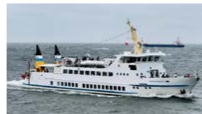
MS „Wappen von Borkum“ (1976; Umbau 1995) Länge: 42,67 m Breite: 7,82 m Tiefgang: 1,06 m Leistung: 2x 380 PS
