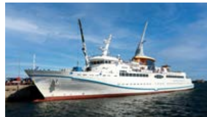
MS „Helgoland“ (2015) Länge: 83,00 m Breite: 12,6 m Tiefgang: 3,60 m Leistung: 4.030 kW Geschwindigkeit: max. 21 kn
