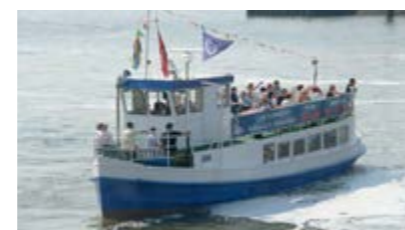
MS „Otter“ (1923; Umbau 1989) Länge: 18,90 m Breite: 4,75 m Tiefgang: 1,26 m Leistung: 1x 147 kW
