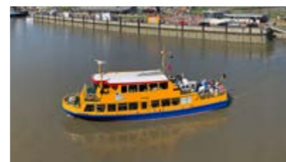
MS „Störtebeher“ (1989) Länge: 26,07 m Breite: 6,32 m Tiefgang: 1,58 m Leistung: 1x 310 kW
