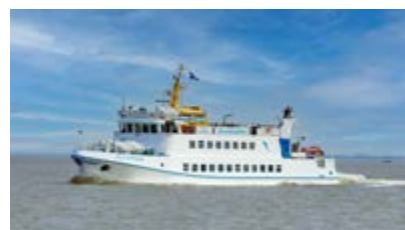
MS „Flipper“ (1977) Länge: 47,00 m Breite: 8,00 m Tiefgang: 1,20 m Leistung: 970 PS Geschwindigkeit: 12 kn
