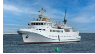
MS „Funny Girl“ (1973) Länge: 68,57 m Breite: 10,00 m Tiefgang: 2,25 m Leistung: 3.800 PS Geschwindigkeit: 19 kn
