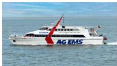
MS „Nordlicht“ (1989) Länge: 38,80 m Breite: 9,44 m Tiefgang: 1,55 m Leistung: 2x 2.774 PS Geschwindigkeit: 38 kn
