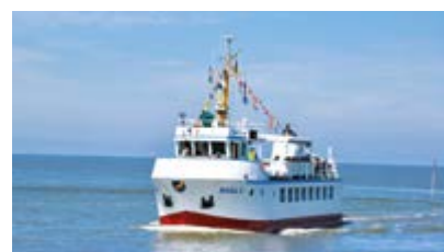
MS „WEGA II“ (1986, Umbau 2020) Länge: 24,50 m Breite: 6,00 m Tiefgang: 1,10 m Leistung: 2x 150 PS Geschwindigkeit: max. 9,3 kn
